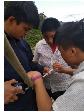
在量竹子的粗度的時候，我們用棉線繞一圈做 記號，再拿到捲尺上面測量長度，因為前面有 小鐵片，賴老師說從一公分開始量再扣回去比 較準確
