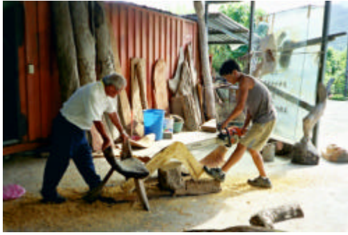
(17) 老人指導切割的造形，並說明功能，作為橫樑與立柱之間的平衡與支撐。
