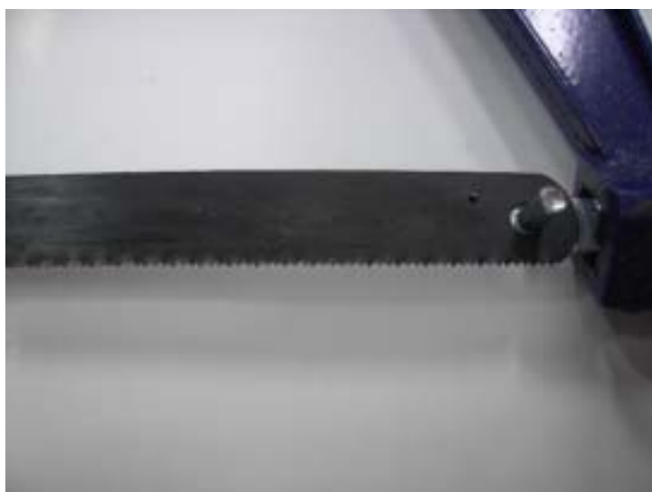
圖 3 金工鋸鋸齒特寫
