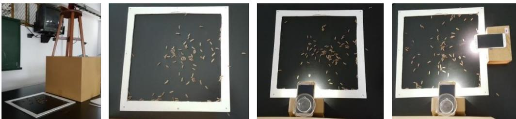
圖五：由左至右為：實驗裝置、無照光移動情況、單側照光移動情況、兩側照光移動情況。
