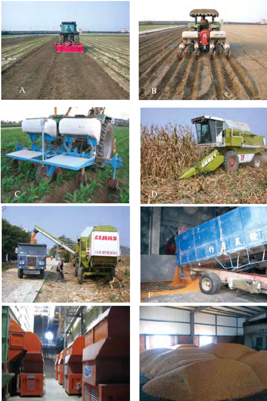
圖 1、飼料玉米機械栽培處理作業 A. 機械整地工作 B. 機械施基肥及播種工作 C. 機械追肥及中耕培土工作 D. 機械採收硬質玉米 E. 收機輸送玉米粒 F. 玉米粒倒入烘乾機 G. 玉米粒進行烘乾作業 H. 乾燥後的硬質玉米粒
