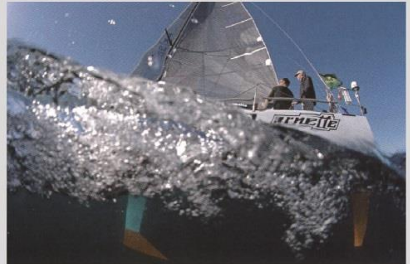
帆船水面下的「中央板」或「龍骨」，對於抵抗側移有很大的幫助
