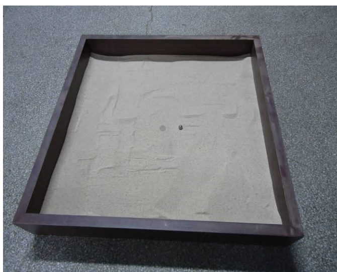
圖 3-4 測量鋼球落地的沙盤
