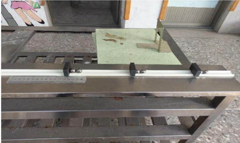
圖 24：裝置改用 40 mm x 25 mm x 10 mm 磁鐵（擺橫）
