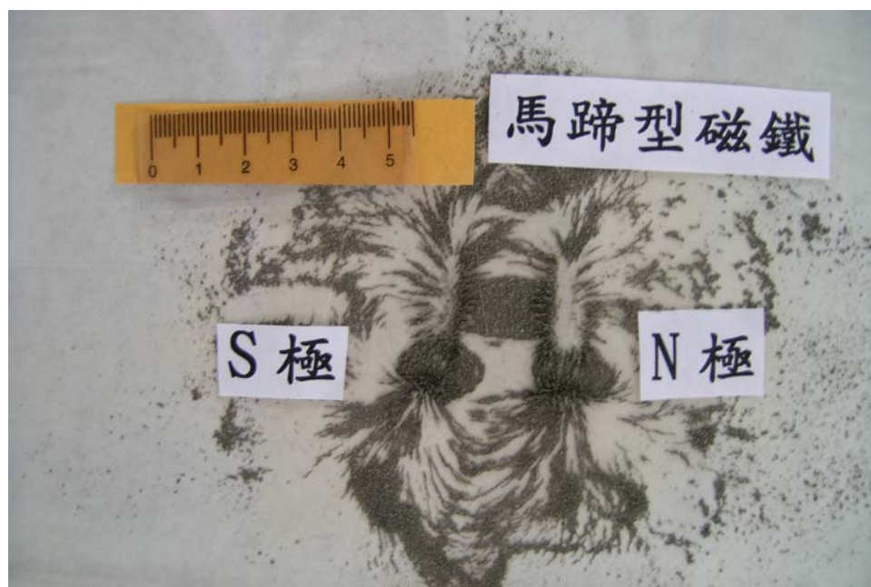
照片四 馬蹄型磁鐵的磁力線
