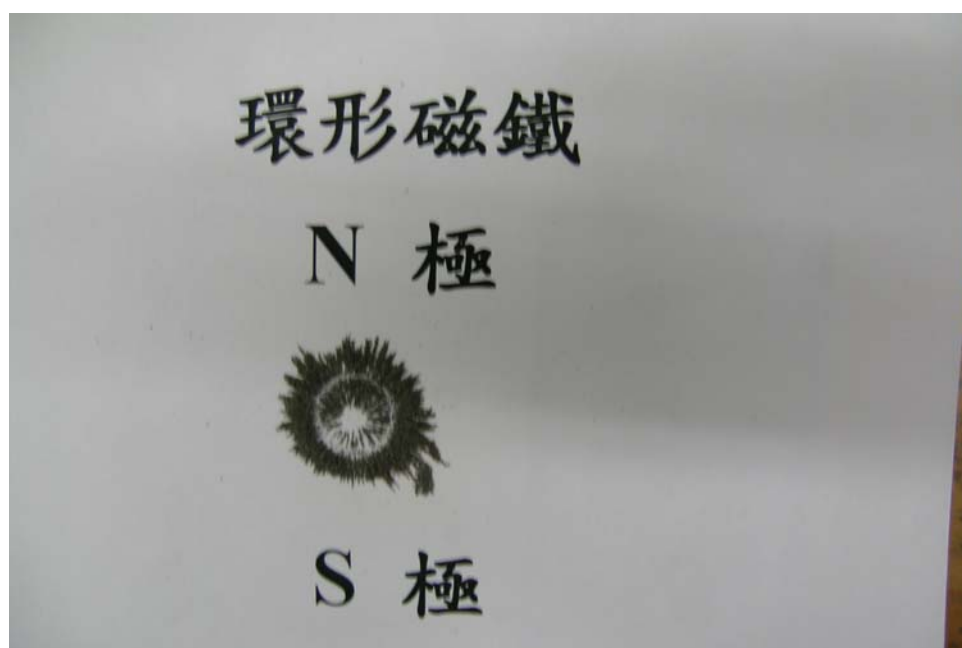
照片九 環狀磁鐵扁平面朝上的磁力線
