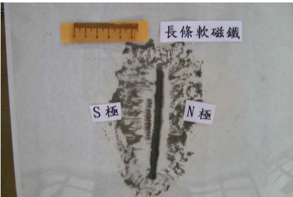
照片十二 長條軟磁鐵的磁 力線
