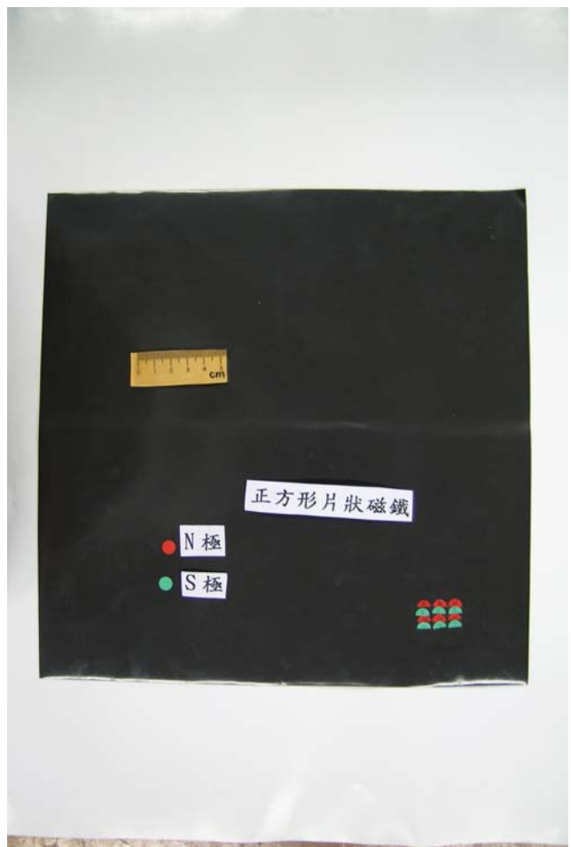
照片二 正方形片狀磁鐵的磁極排列方式
