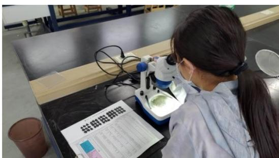
照片 43：以解剖顯微鏡觀察鐵砂圓球度
