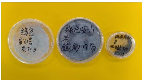
照片 45：綠色安山岩鐵砂與磁鐵砂含量
