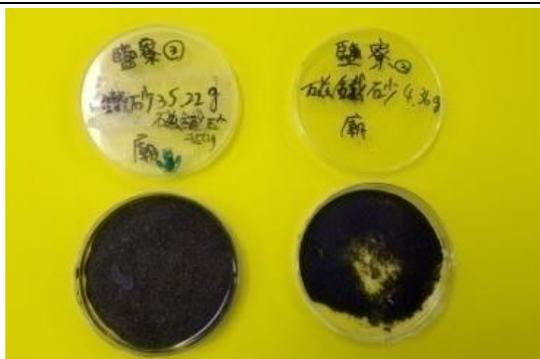
照片 41：泡水觀察鐵砂與磁鐵砂
