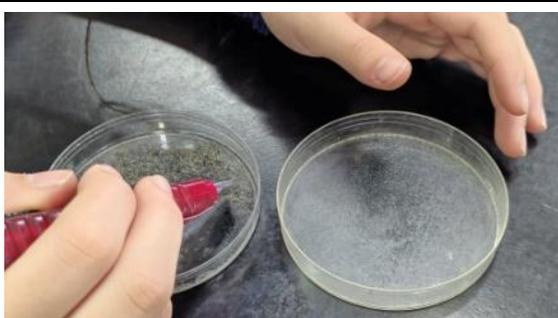
照片 39：以刀片分離磁鐵砂
