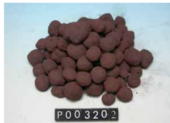
圖 7. 粉鐵礦與助溶劑燒結而成的球形燒結礦（為中國鋼鐵公司所捐贈之標本及本館蒐藏編號）。
