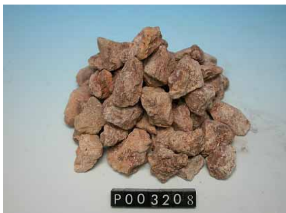
圖 6. 白雲石。於煉鐵過程中做為助溶劑使用。（為中國鋼鐵公司所捐贈之標本及本館蒐藏編號）。
