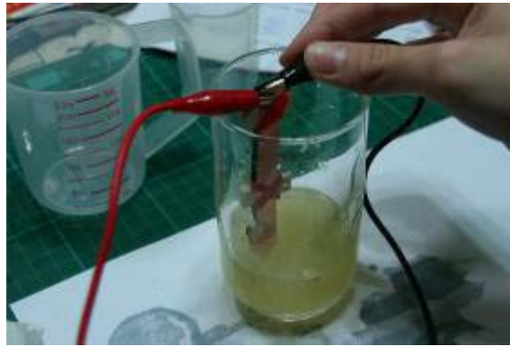
照片 9 測量電解質濃度與電壓、電流的關係
