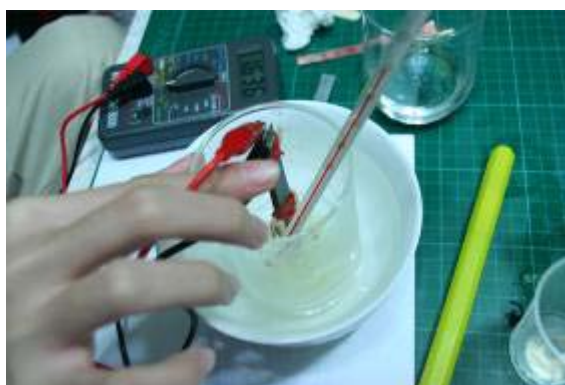
照片 10 測量電解質溫度與電壓、電流之關係圖
