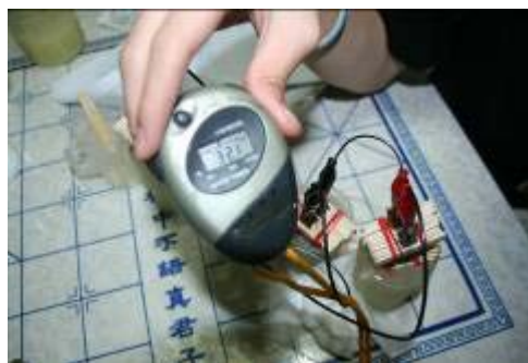
照片 17 基本電極模組可以使數位式碼錶顯示
