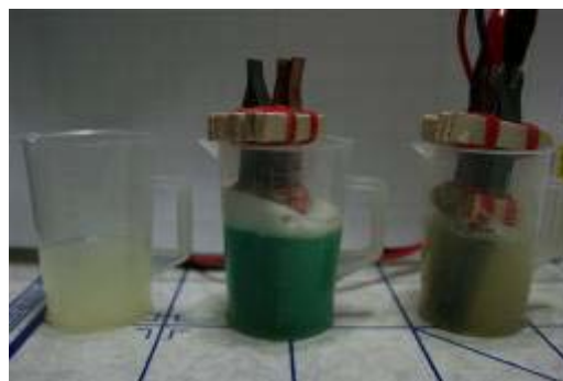
照片 25：左（檸檬汁加雙氧水）；中（檸檬汁加雙氧水加電極）；右（檸檬汁加電極）
