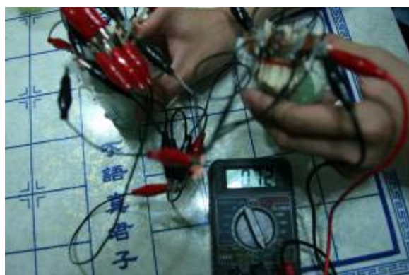
照片 15 並聯 2 組改良式電極模組，電流已經達到 A（安培）的刻度級數
