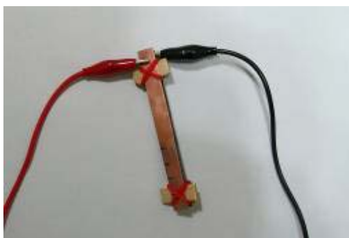
照片 8 以冰棒棍固定兩電極間的距離
