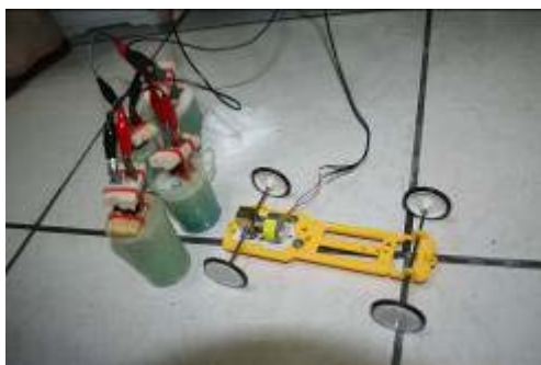
照片 18 基本電極模組可以驅動小型電動車
