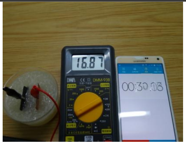
單一組鎂鋁-銅果凍電池電流值約 16.87 mA
