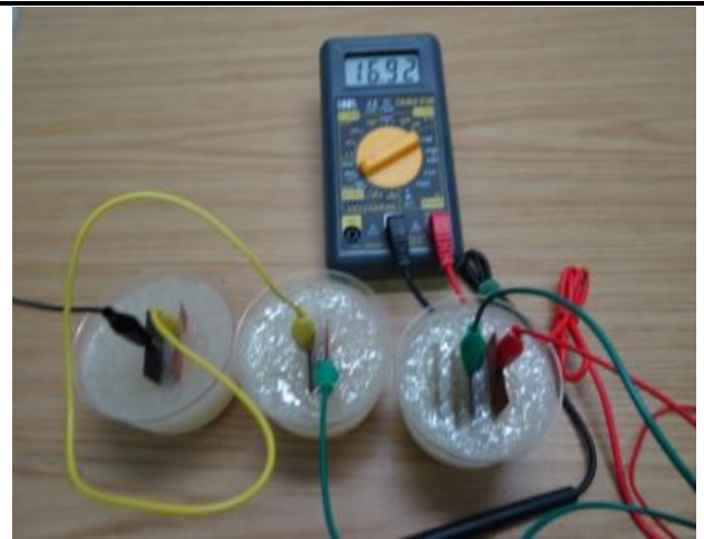
串聯三組鎂鋁-銅果凍電池電流值約 16.92 mA
