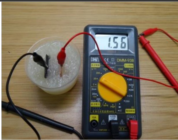
單一組鎂鋁-銅果凍電池電壓值可達 1.56 V
