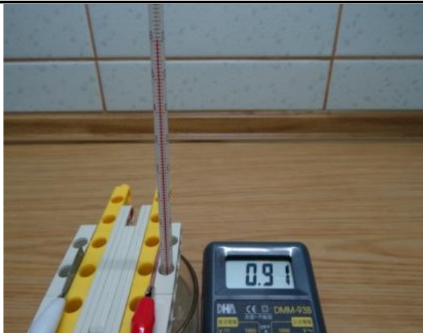
當電解液 60°C時測量的電壓值(鋅-銅)
