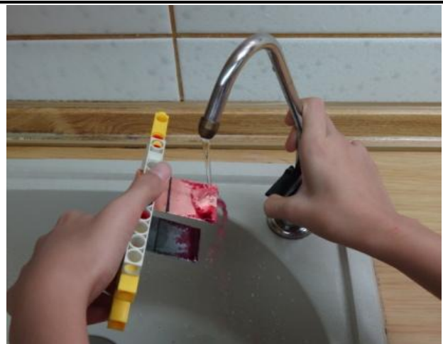
每次測量後均需將電極沖水擦乾，再進行下一次測量
