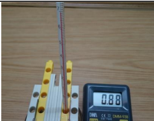
當電解液 70°C時測量的電壓值(鋅-銅)
