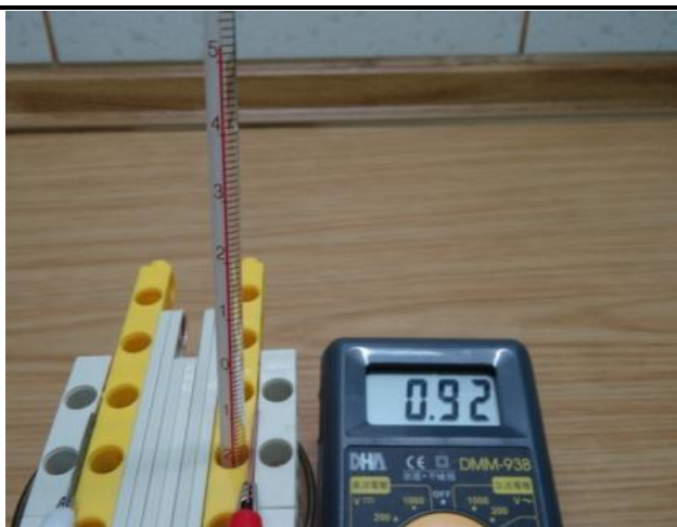
電極模組也可插入溫度計來監視溫度變因
