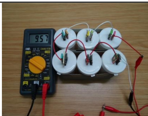
串聯六組簡易電池組電壓可達 9.57 V (以回收銅箔基板—鎂鋁合金外殼當電極金屬)
