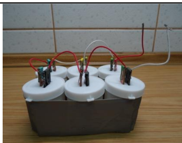
串聯六組簡易電池組的側面照 (以回收銅箔基板—鎂鋁合金外殼當電極金屬)
