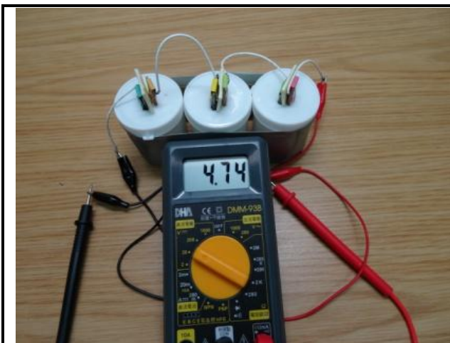
串聯三組簡易電池組電壓可達 4.74 V (以回收銅箔基板—鎂鋁合金外殼當電極金屬)
