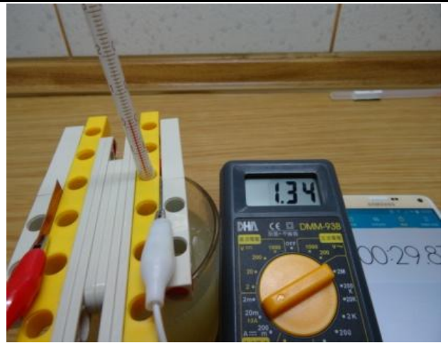
當電解液 0°C時測量的電流值(鋅-銅)
