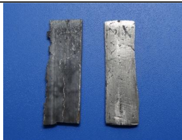
檢回後用砂紙將表面保護膜磨掉可當負極電極使用
