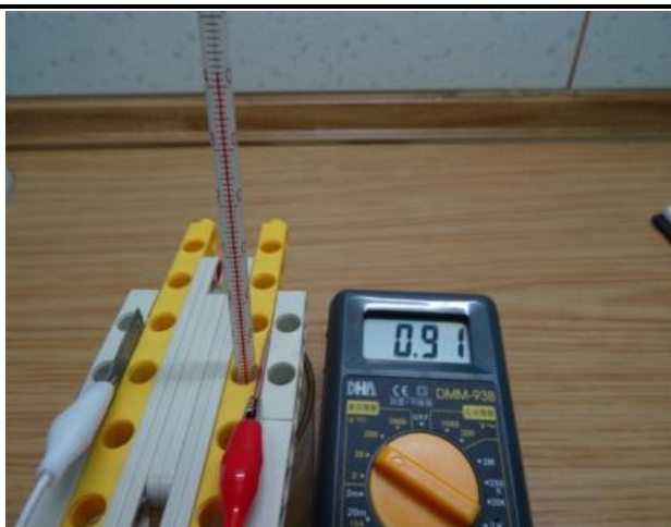
當電解液 20°C時測量的電壓值(鋅-銅)
