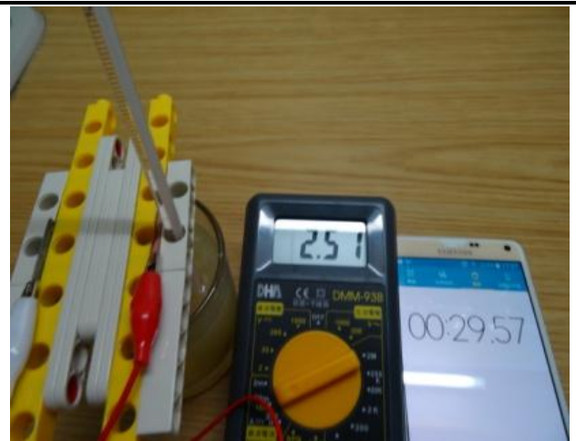
當電解液 20°C時測量的電流值(鋅-銅)
