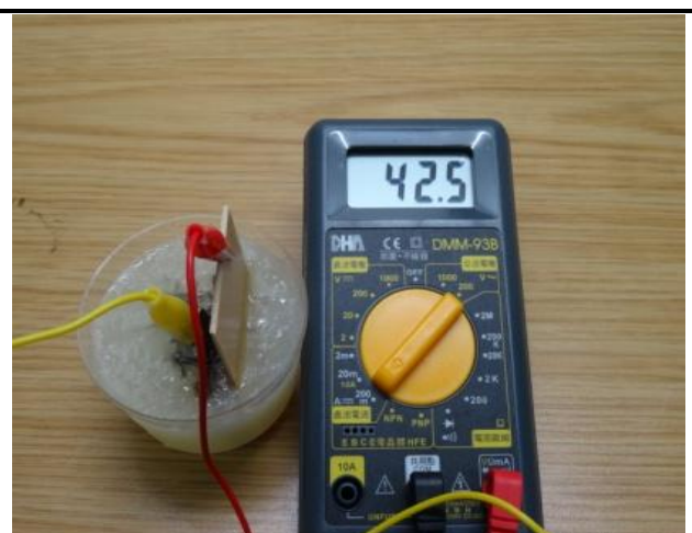
利用回收金屬當電極所做成的果凍電池，單組電池電流值為 42.5 mA
