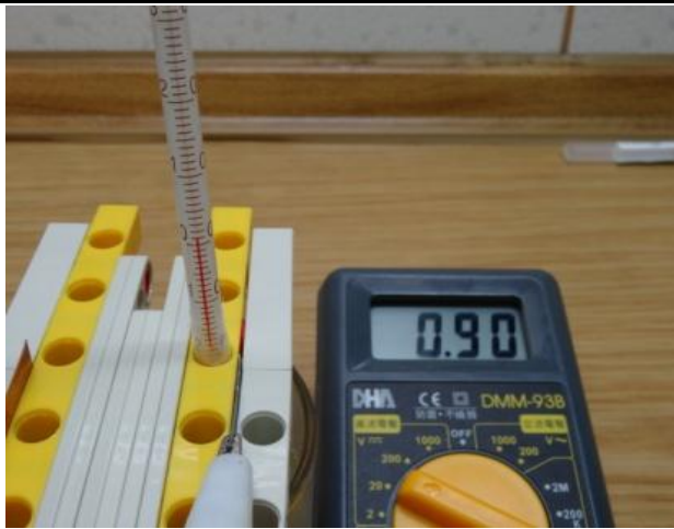
當電解液 0°C時測量的電壓值(鋅-銅)
