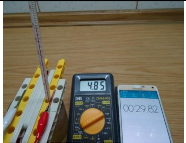
當電解液 50°C時測量的電流值(鋅-銅)
