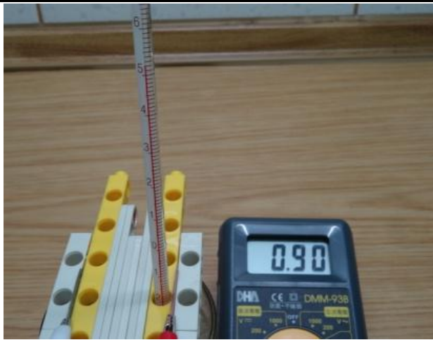
當電解液 50°C時測量的電壓值(鋅-銅)
