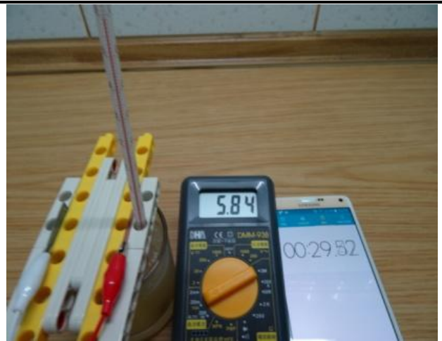
當電解液 60°C時測量的電流值(鋅-銅)
