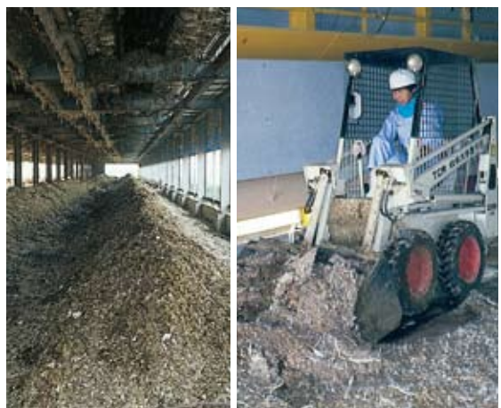
左圖高床式及右圖之平飼雞舍都可利用鏟裝車清除雞糞
