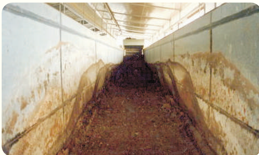
圖2-2-4. 杓子式發酵槽。
