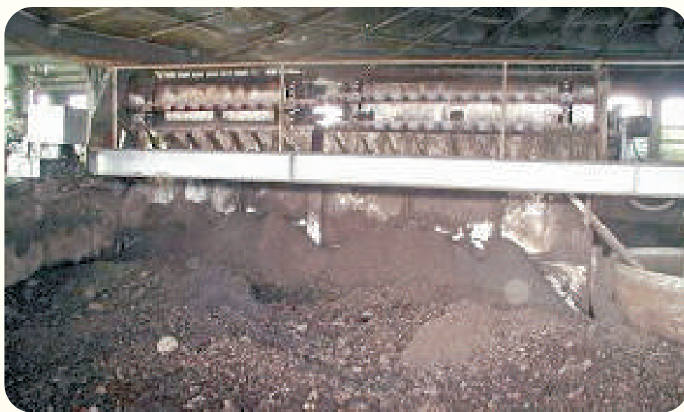
圖2-2-3. 刀爪迴轉攪拌式發酵場。
