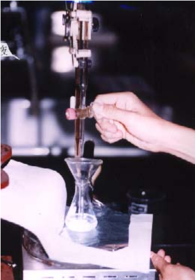
照片說明 4：利用丙酮溶劑特性滴定廢棄硫酸銅水溶液
