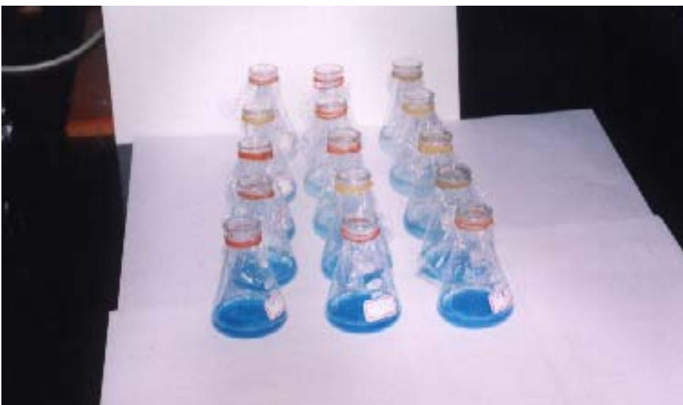
照片說明 5：各組不同濃度廢棄硫酸銅水溶液，加入丙酮後靜置 24 小時
