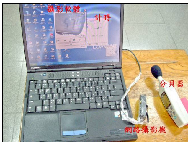
圖2. 測量實際教室內噪音之裝置
