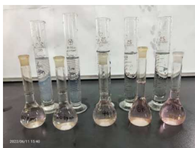
步驟 15-1 配製 \text{Co}^{2+} 、 \text{Ni}^{2+} 溶液
