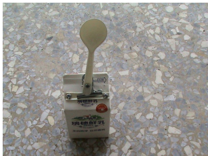
圖二、以牛奶盒為底座的投石器 【簡單易做，5分鐘完成，缺點是射程不遠】
