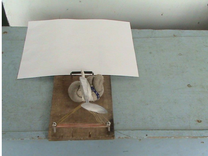
圖五、以老鼠夾為底座的投石器（橡皮筋容易彈性疲乏）
