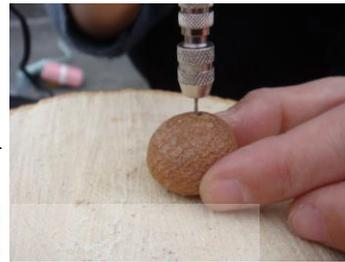
圖80使用迷你電鑽鑽孔
