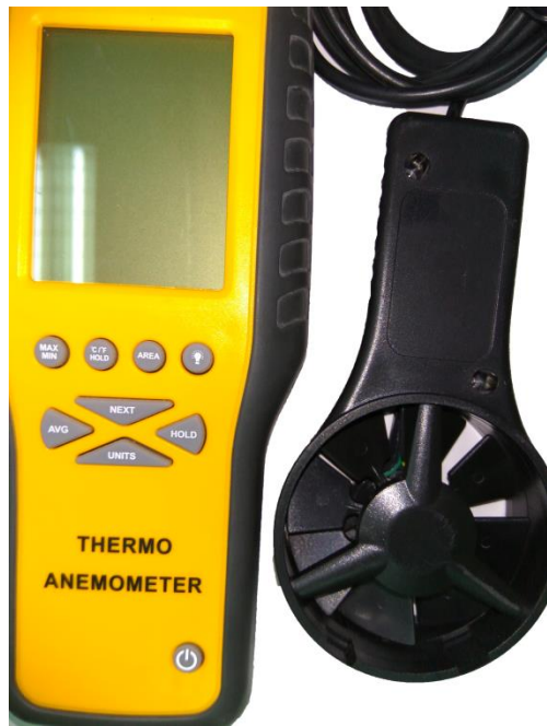
(a)量測進氣口風扇之風速計
