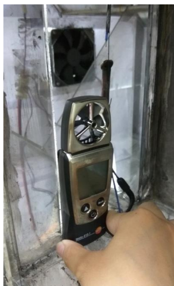
(a)固定點風速量測(原先 測量方法)
