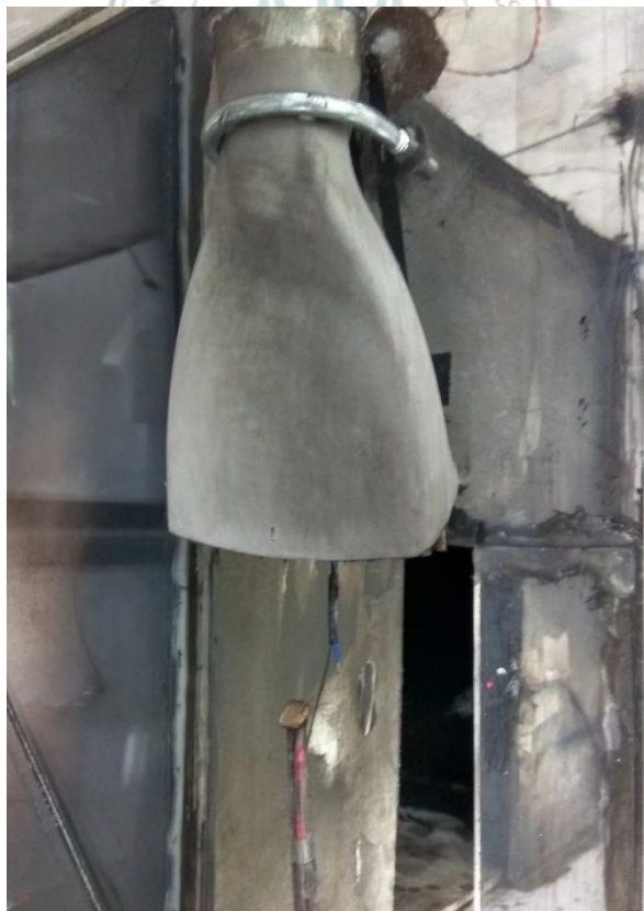
圖 3.20 氣簾裝設於模型示意圖
