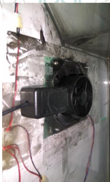
(b)進氣口風速量測
