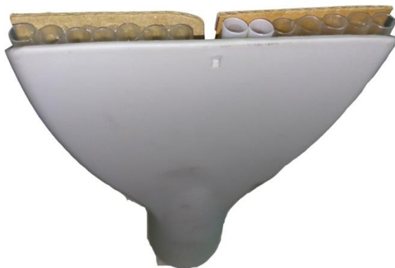
圖 3.37 整流過後之氣簾模型
