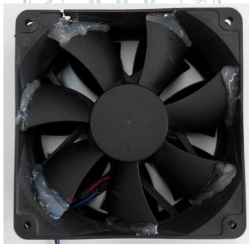
(a)整流風罩為將另一風扇轉向並固定扇葉
