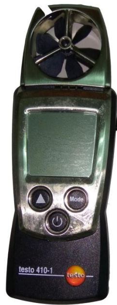
(b)量測排氣口風扇之風速計
