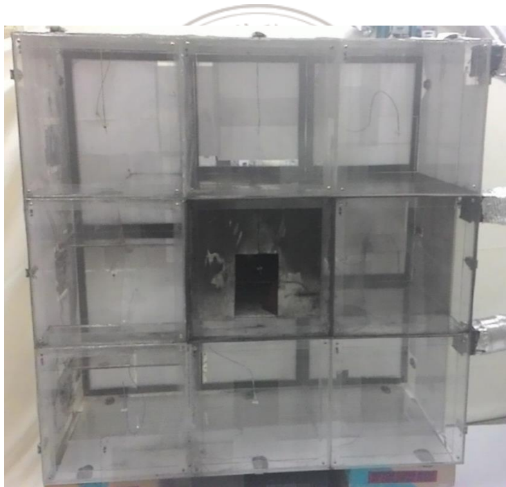
圖 3.17 小尺度 (1:10) 尺寸壓克力實驗模型外觀
