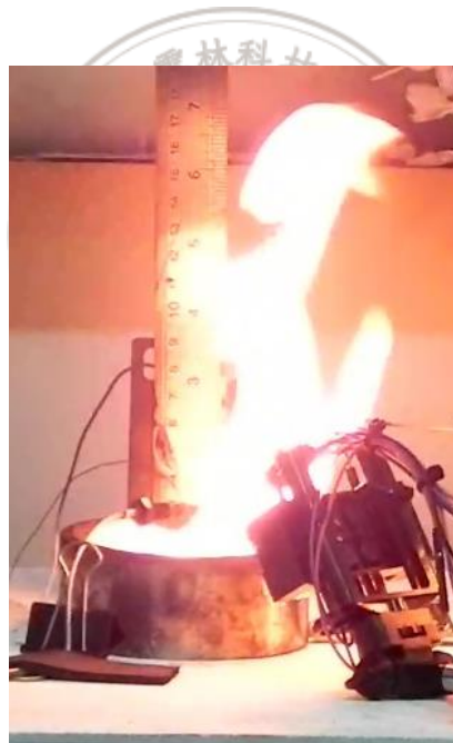
圖 3.3 實驗測定火焰高度
