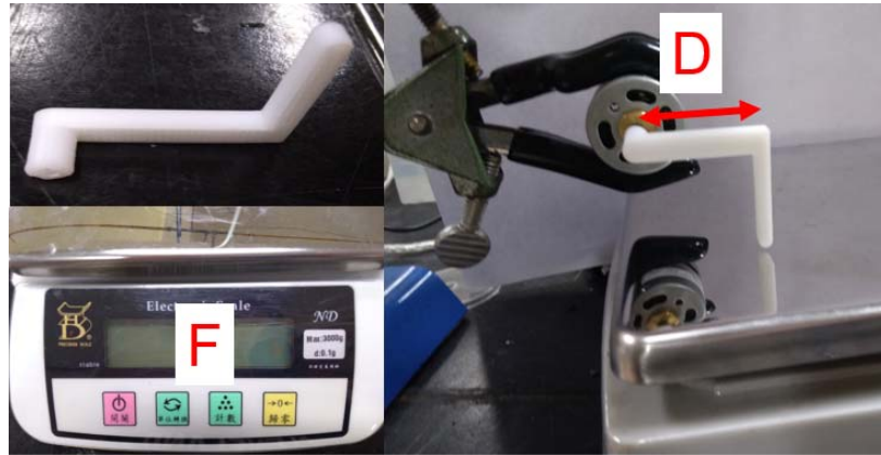
圖 4.21 簡易量測馬達力矩方式
