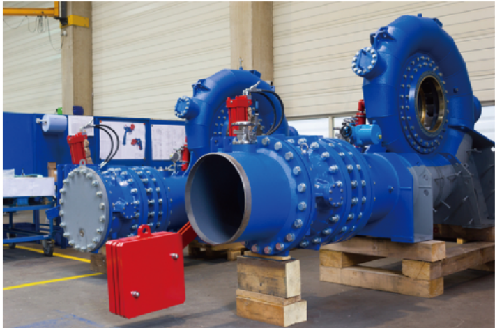
法蘭西斯水輪發電機組
