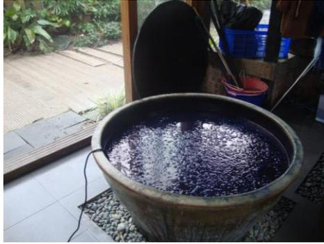
圖 21 卓也小屋的染缸以保溫棒維持染缸溫度。筆者攝
