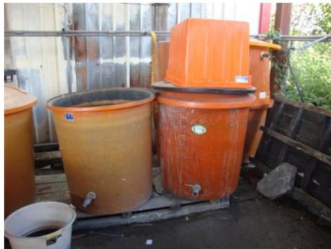
圖 44 靛花青的浸泡沉澱桶，上方裝設水管方便接水，下方裝設水龍頭以排水。筆者攝
