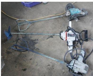
圖 50 靛花青工房使用的電動攪拌器。圖片提供：靛花青工房
