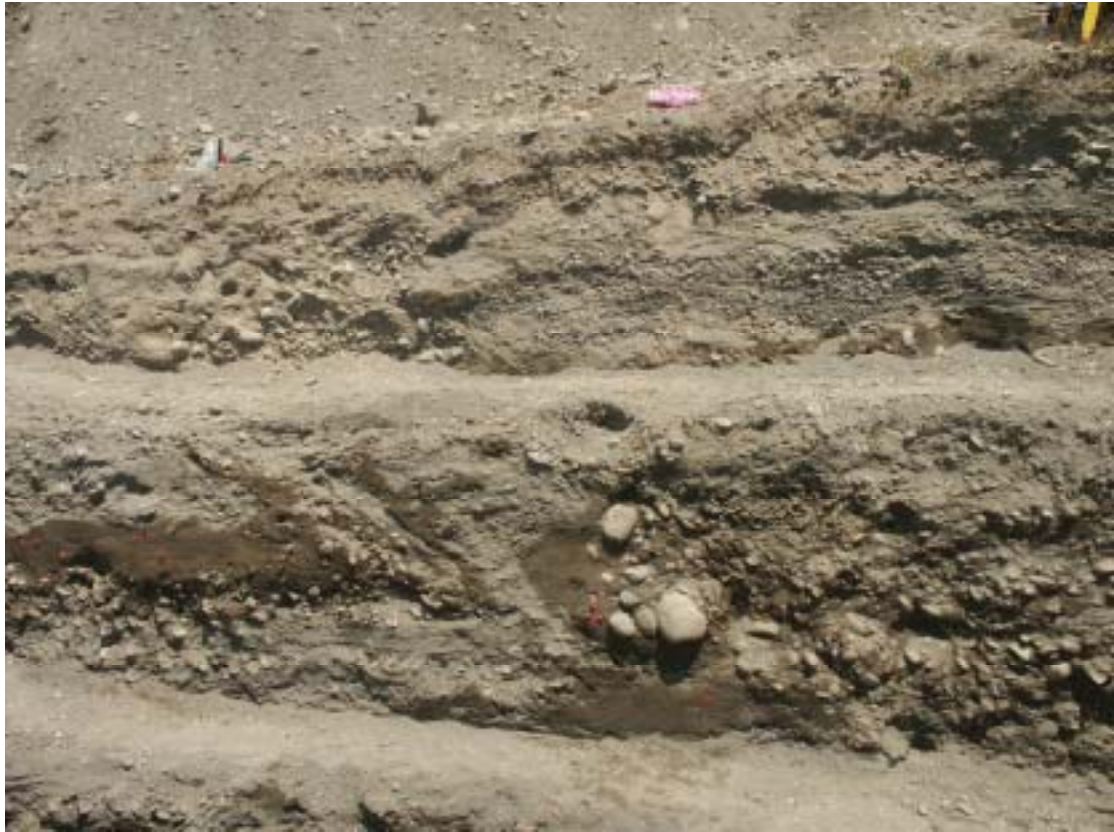
圖 5. 花東縱谷斷層造成砂礫層形成扭曲褶皺。
