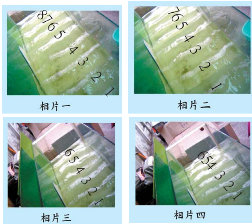
圖一、連續抖動薄瓦楞板產生波動，由魚缸上方觀察波浪由深海進入淺海的變化
