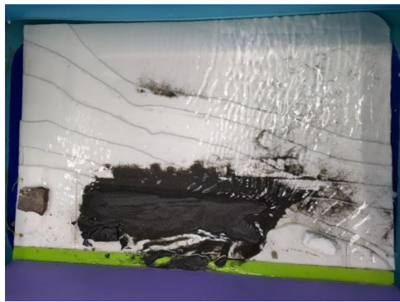
圖 28：放置海砂測試，為增加模型重量，底下黏鐵板
