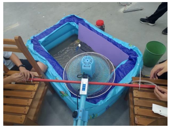
圖 29：固定電扇，電扇懸空不和充氣泳池接觸，以防震動。
