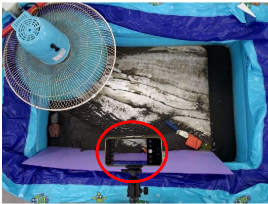
圖 30：風扇模擬東北季風，並固定相機，以確定拍照能定位
