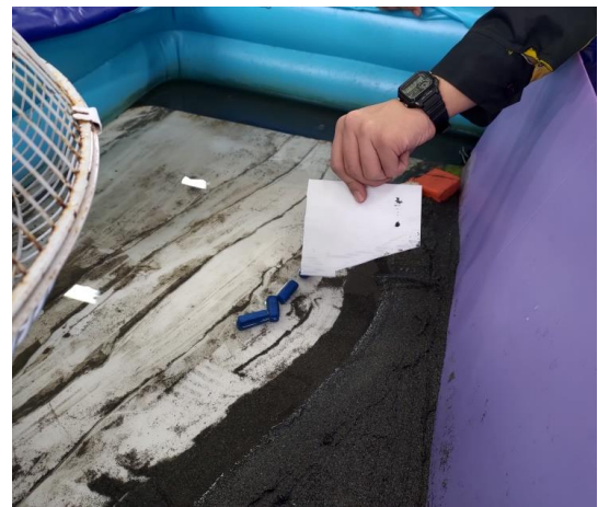
圖 33：復原模型：用瓦楞板製作 20 度斜
