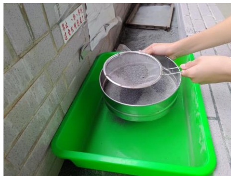
圖 18：過篩法分離各種粒徑的砂石
