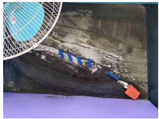
圖 31：以黏土加鉛塊製作離岸潛堤。
