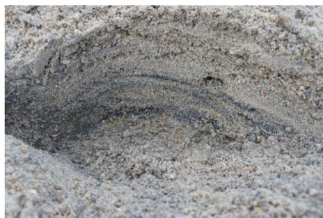
(三)位於低潮線之樣本加水攪拌的結果中，其白色細沙在上層，而黑沙幾乎都沉澱在第二層，而較透明的粗顆粒在第三層，最底層則有些許黑沙。
