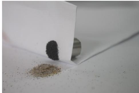
(三)高潮線附近的沙子中，一平匙的沙子中可被強力磁鐵吸引的數量，較低潮線附近的沙子中多。表示高潮線附近的沙子中含磁鐵量較高，低潮線附近的沙子中含鐵量較低。
