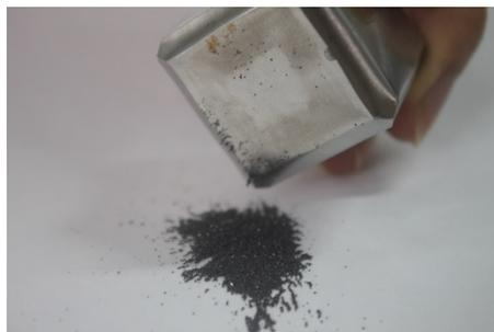
(五)天然的磁鐵砂與實驗室專用的鐵砂都可做出磁鐵的磁力線實驗，且可觀察到天然磁鐵砂的光澤度較高。
