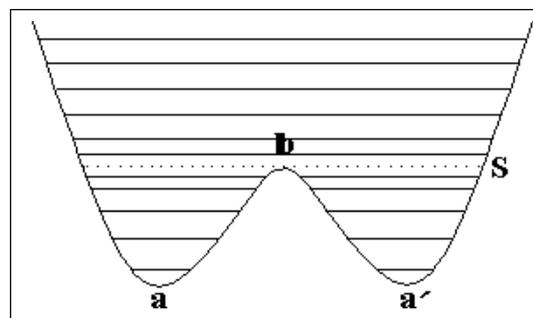
圖七：兩個化學鍵振動耦合的勢能。水平線表示能級。 $a, a'$  為穩定的不動點， $b$  為不穩定的不動點。 $S$  為分界線。
