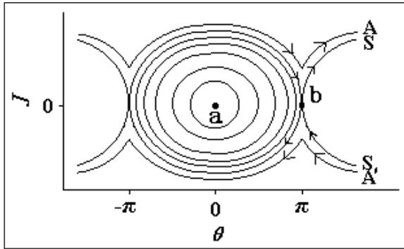
圖二：單擺運動的相圖。 $J$  為速度， $\theta$  為相角。曲線對應於不同能量的軌跡。箭頭表示軌跡的方向。 $A, A'$  表示方向相反的轉動， $S$  為分界線。
