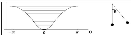
圖一：單擺的勢能。勢阱中的橫線表示各種能量時的情形。
