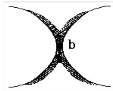
圖三：在不穩定不動點，b，附近的軌跡糾纏在一起，從而產生混沌結構。
