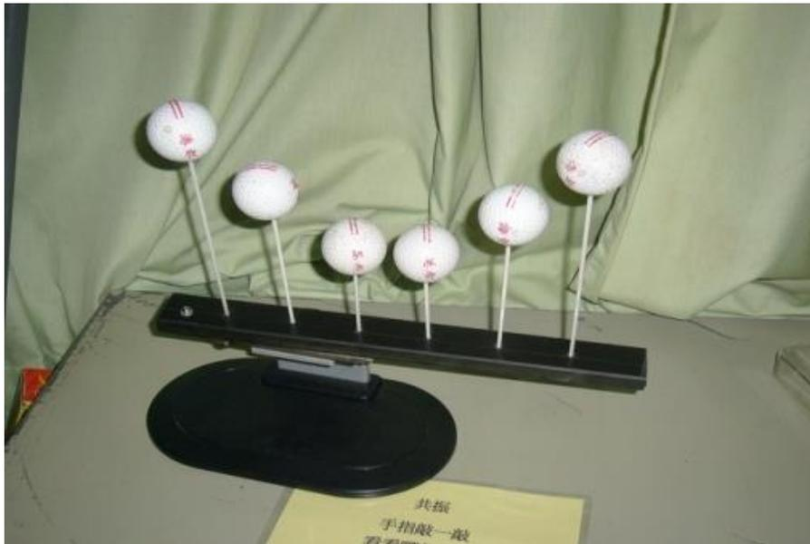
圖 3：共振球，右側為三個振動子，左側共振球則可視為振動子的驅動力。
