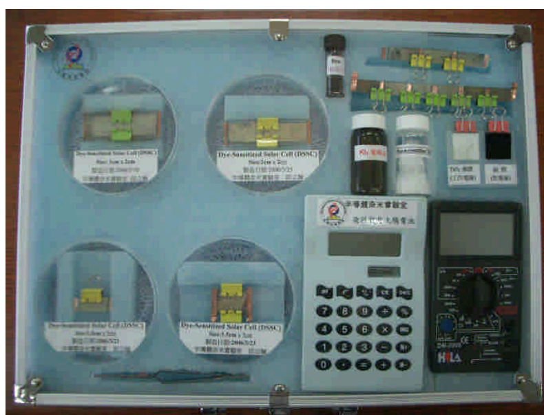
圖 9.6-16 自製的染料敏化太陽電池展示盒
