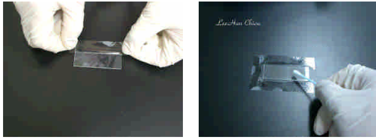
圖 9.6-4 實驗步驟 4：略具厚度( \sim 40\text{-}50\ \mu\text{m} )的 3M 膠帶貼附於玻璃基板的三側邊，再另外用較寬的膠帶將基板固定於實驗桌面上，
