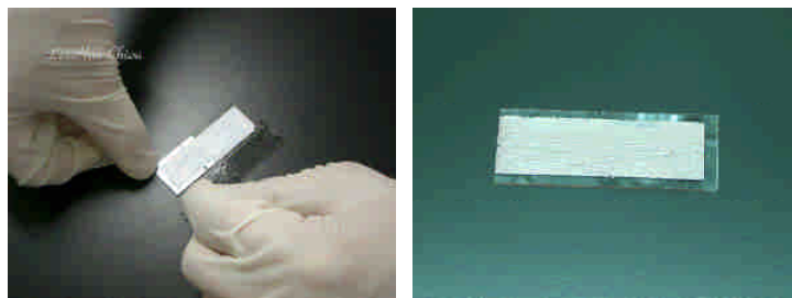
圖 9.6-6 實驗步驟 6：用鑷子小心地除去玻璃基板上黏貼的膠帶。
