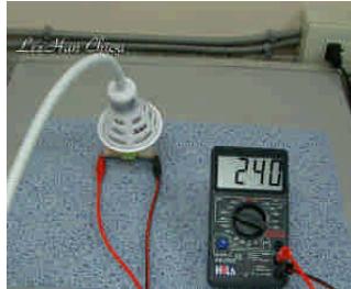
圖 9.6-14 實驗步驟 14：以白熾燈泡所產生的光源取代戶外的陽光，照射製備所得的太陽電池表面，然後使用三用電表觀測電池罩光前後所產生的電壓和電流變化。
