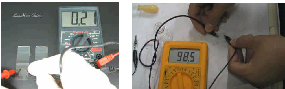
圖 9.6-3 實驗步驟 3：用三用電表檢測透光導電玻璃基板表面導電層之導電度
