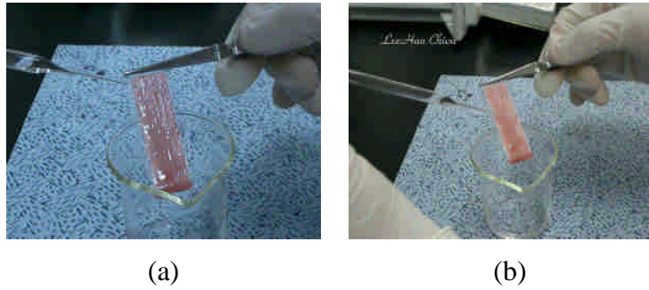
圖 9.6-9 實驗步驟 9：(a)以蒸餾水或去離子水沖洗浸漬過染料的玻璃基板，(b)接著再用乙醇溶劑沖洗，將附著於膠質層內的奈米級孔洞中不易自行揮發的水分清除乾淨。
