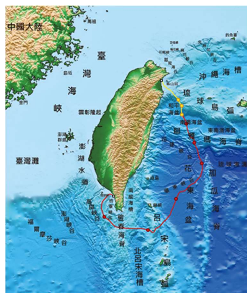
圖 3.1.10 臺灣東部海域地震海嘯海纜觀測系統鋪設路徑與海底觀測站位置圖。
