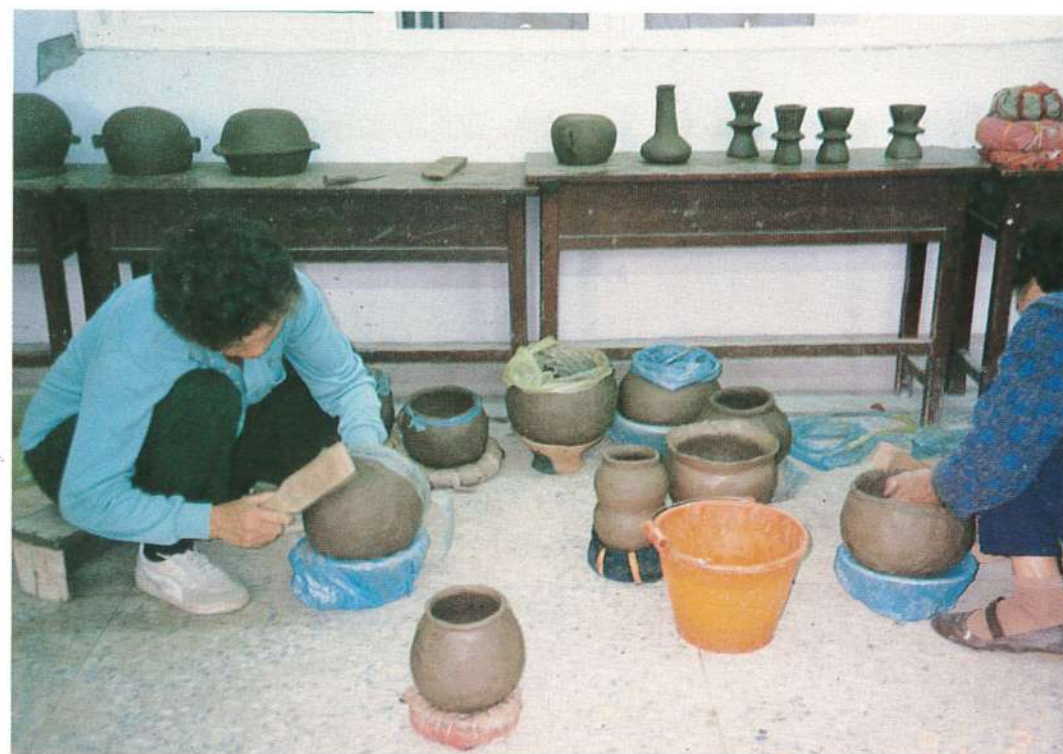
拍打製作及成品（陶口綁塑膠袋固定作用以免變形。）
