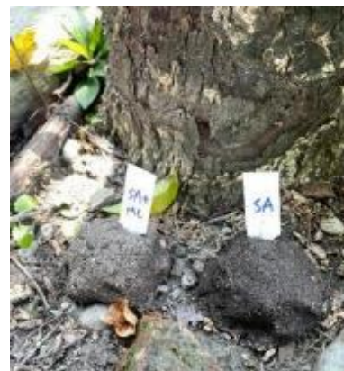
圖 33、SA 種子球與 SA+MC 種子球於戶外種植 1 天後失水情形，SA 顏色較深代表保水度較好(*圖片出處註 1)
