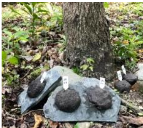
圖 35 SA-0.5 種子球、SA-0.4+MC-0.4 種子球 與對照組第一天投擲岩板附著情形 (*圖片出處註 1)
