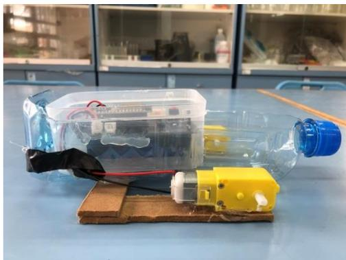
(2)進水問題:儘管有使用熱熔膠加上絕緣膠帶將線路的接口封死，但在經過幾分鐘的測試後仍然會進水，影響到Arduino板。
