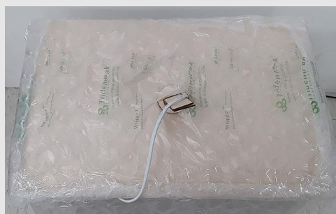
▲圖 12：將白熾燈泡置於「實驗箱」中，再把泡棉包覆，隔絕熱的散逸。
