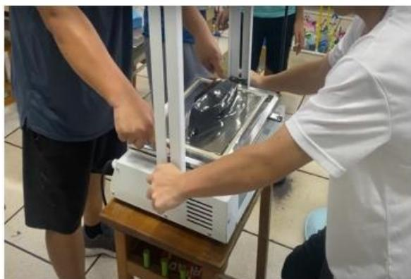
圖 8 真空成型機壓製船模
