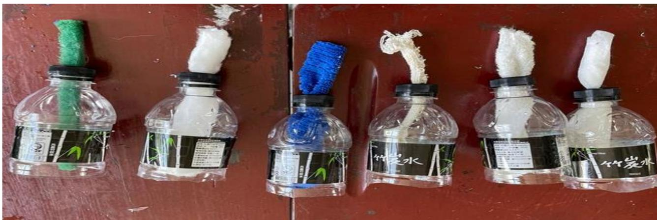
圖 9 將不同材質剪成一樣的長度及重量
