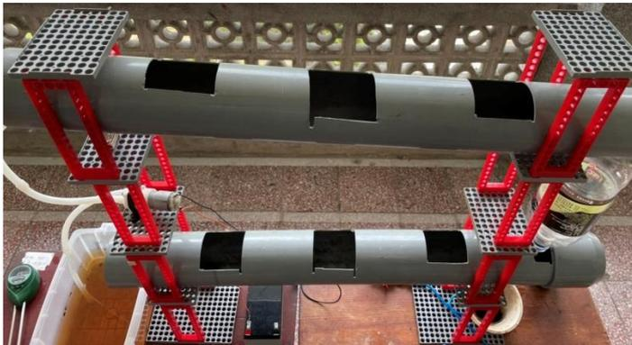
圖 7 將水循環系統設置在雙層模組(可擴充)
