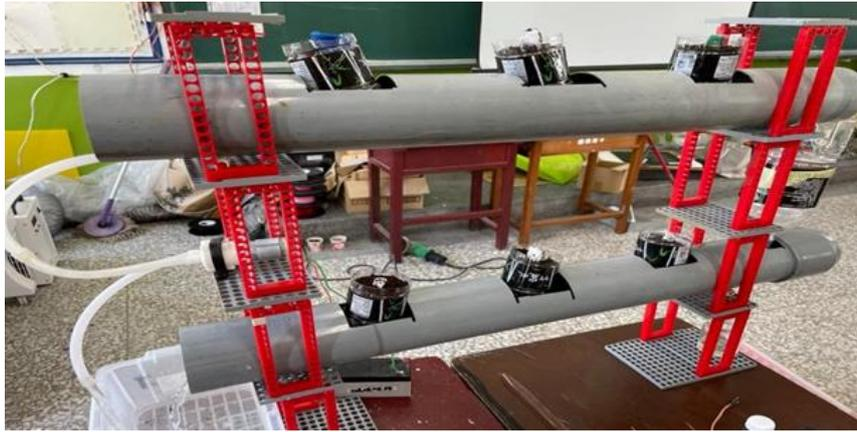
圖 10 依序將不同材質放置孔內(並讓水一直循環流動)
