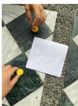
圖 25、用強力磁鐵檢測， 確定是蛇紋岩
