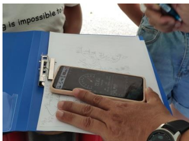
使用手機分貝計 APP 測量竹鐘發出聲音的音量
