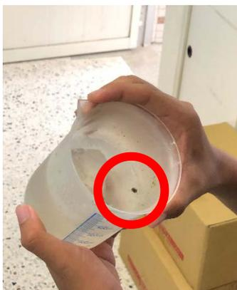
圖十三、經過冷凍的汗水，可以看到不乾淨的分和純水已經被清楚的分開，中間的髒水並未結冰，最下層只有一層薄冰，博冰碎裂後，髒水流出，剩下的便是乾淨的純水。不過沒有專業的儀器檢查，不確定是否可以食用。
