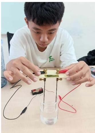
在電解淡化的結果中，我們驚訝地發現完全達不到淡化的效果，也因為一部份的水被蒸發，所以反而使瓶中水的鹽份變得更高，後來知道此技術只能製造氫氣，淡化的效果微乎其微
