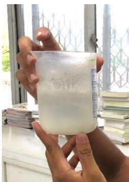
我們發現冷凍並不能完全把鹽和水分開，但比起蒸餾的方式，冷凍的效率比起蒸餾的方式較佳
