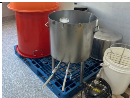
過去傳統的裝罐法，需要人工一瓶一瓶裝，且常常溢出
