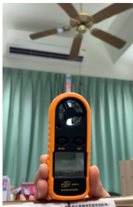
圖 22. 未開吊扇之冷氣風速
