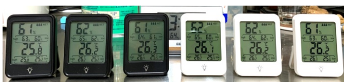
圖 2. 原購得之 6 個溫度計除最左外溫差在 0.2^{\circ}\text{C} 內
