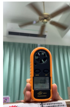
圖 23. 吊扇開啟後之冷氣風速
