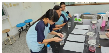
照片十四:燒乾幾種水，觀察比較殘留物，並將兩公克肥皂與 150 毫升三種水混合觀察比較。
