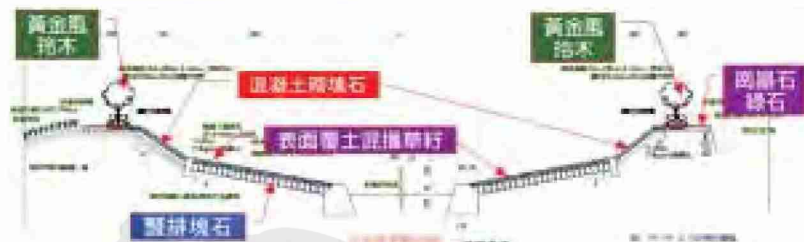
圖 7 多階式護岸施工現況圖
