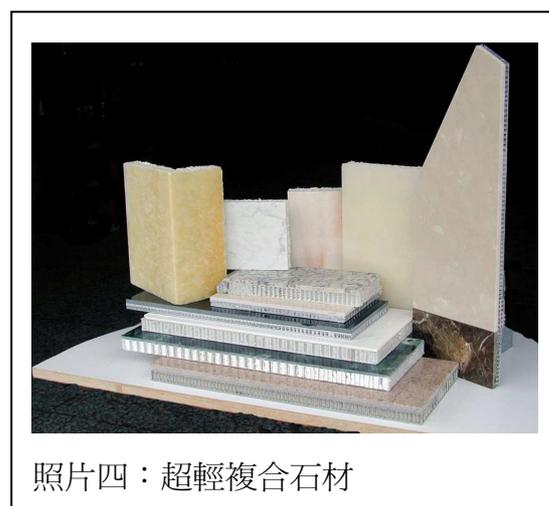
推出之初，正值台灣建築業衰退期，且石材薄板加工及背襯材料成本極高，市場上對於複合石材反應並不熱烈，使得剛推出的那段時期極為辛苦，也曾經想過是否要放棄。約一年後，921 大地震發生，王董事長認為超輕複合石材在抗震防災市場上的確深具潛力，內裝用石材在此時有了出頭的機會，開始將 FRP 複合石材用於大樓電梯內部和內部牆面裝潢，又與許多建築師討論防火的需求，再結合德國製的鋁蜂巢板的複合石材，終於創造出輕薄又兼具防火功能的「超輕複合石材」。
