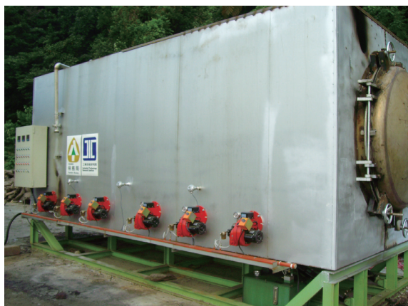
▲照片6 批量式大型漂流木炭化爐。
