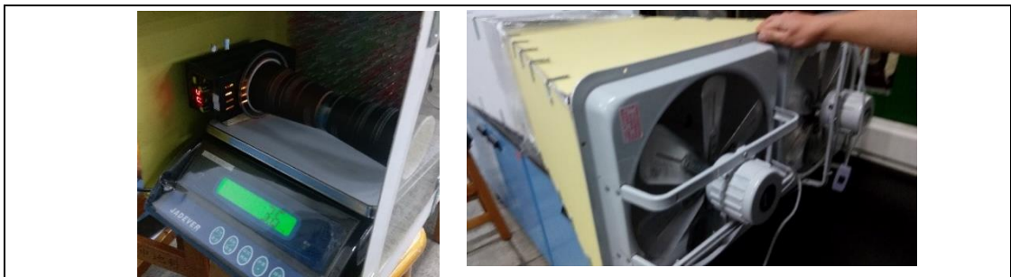
圖十四：自製風洞裝置 (圖十四資料來源：研究者拍攝)
