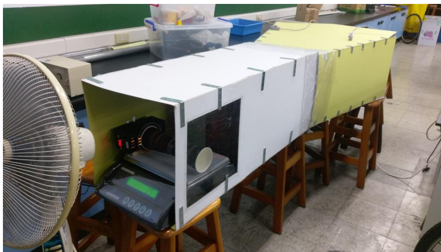
圖十九：風洞實驗的環境 (圖十九資料來源：研究者拍攝)
