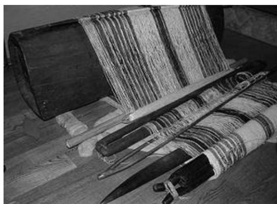
圖十三 織布機，又稱水平式腰織機
