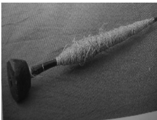
圖八 紡輪<sup>註十</sup>可將鬆散的麻纖維，捻成強韌連續的線
