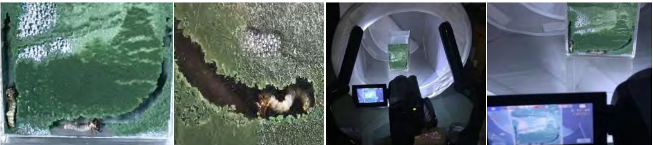
圖 12-1 我們自製第一與第二代幼蟲觀察器，並使用相機及攝影機觀察幼蟲在土表下行為
